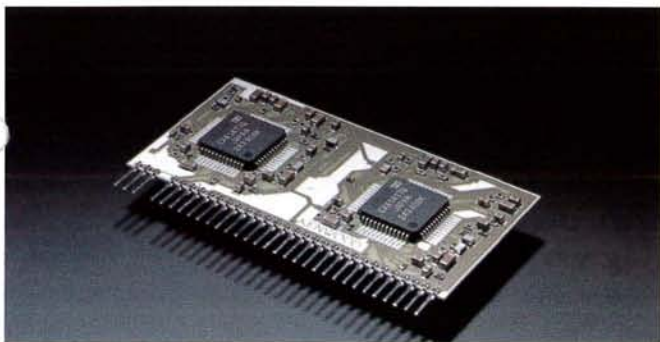
Il nuovo IC ibrido originale Kenwood dispone sia del sistema di riduzione del rumore Dolby-S sia del sistema Dolby B/C NR. Due chip attivano il controllo in tempo reale nel modello a tre testine.
